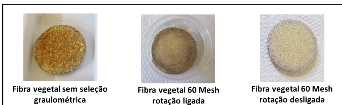
Figura 14 - Pastilhas prensadas de fibra vegetal após leitura no FRX. Fonte: o autor (2019).
