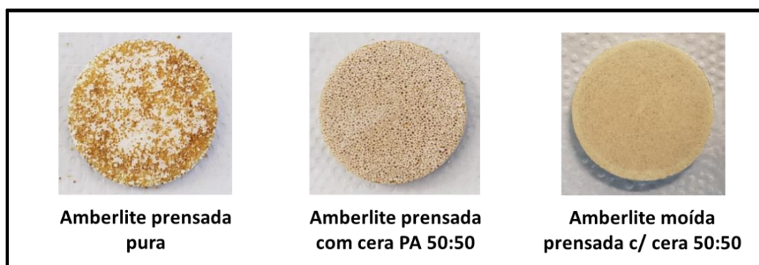
Figura 15 - Pastilhas prensadas de resina catiônica Amberlite. Fonte: o autor (2019).
