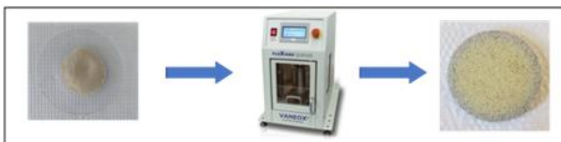
Figura 4 - Preparação de pastilhas via prensagem (20 ton.). Adaptado de Google Imagens (2020)
